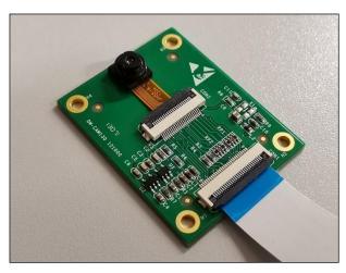
Fig. 2. OV9655 Camera module [23]
