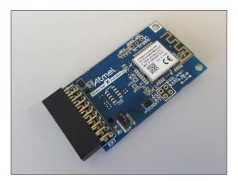
Fig. 3. ATWIN1500-XPRO Wi-Fi module [24]
